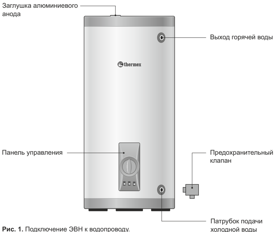
Рис. 1. Подключение ЭВН к водопроводу.
