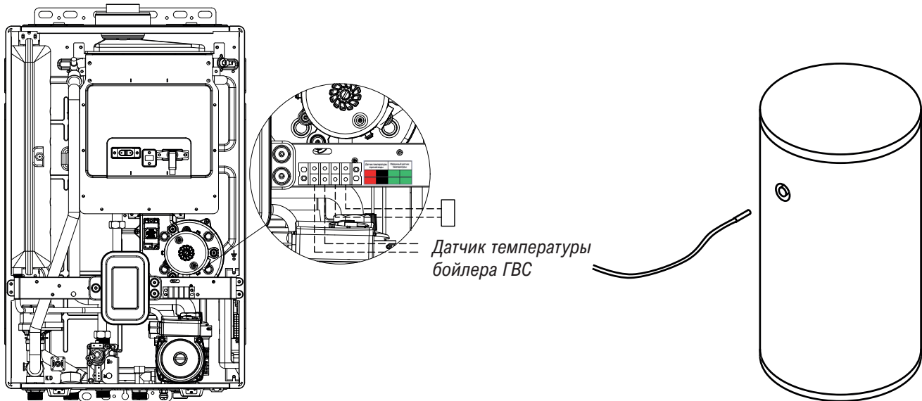
Рисунок 14. Подключение датчика температуры ГВС в бойлере.
