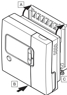
1. Разместите комнатный термостат на монтажной пластине.
